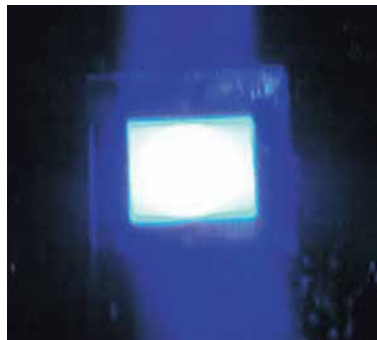
紫外励起用アルカリ土類珪酸塩の青色発光の様子 Blue emission from an UV-excited alkaline earth silicate
